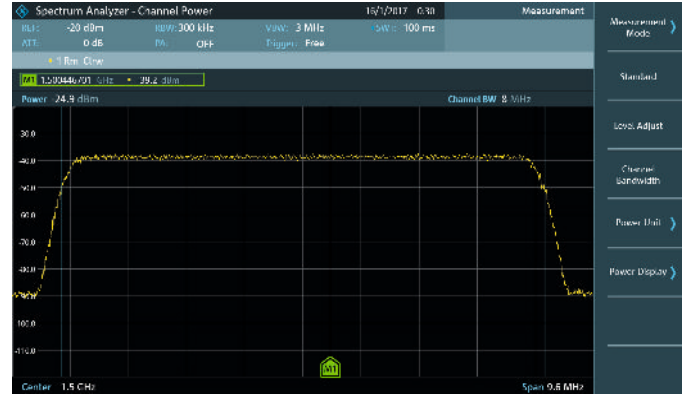
Опция R&S®FPC-K55: измерение мощности в канале
